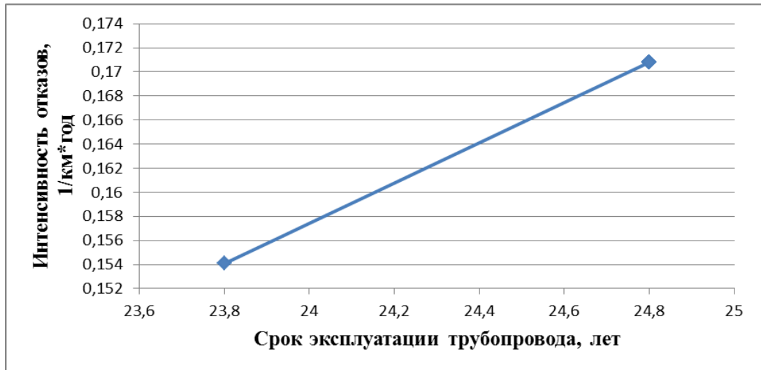
Рисунок 10 – График зависимости интенсивности отказов от срока эксплуатации \lambda(t) = \lambda_0 * (0,1\pi)^{t-1}
