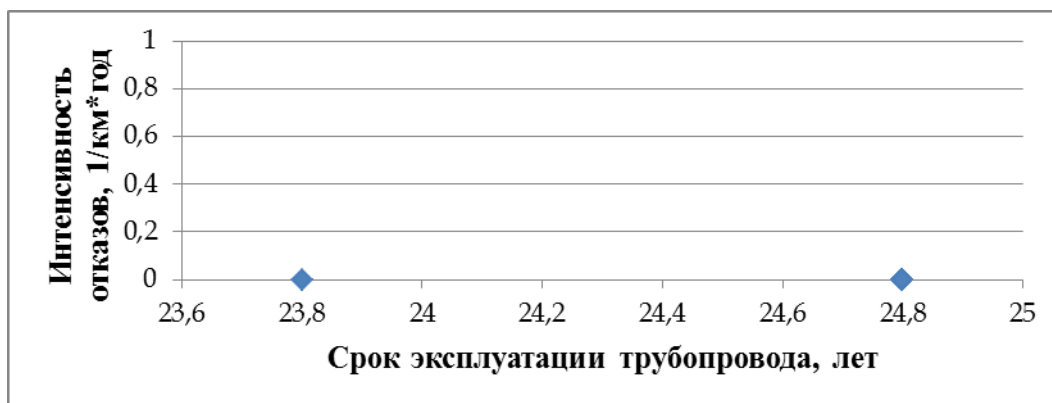
Рисунок 7 – График зависимости интенсивности отказов от срока эксплуатации \lambda(t) = \lambda_0 * (0,1t)^{p-1}
